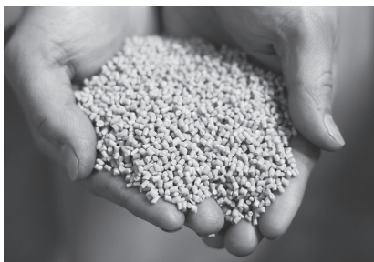
写真5 リペレット化された再生プラスチック材
